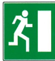
1.101. shenja » Për ndalje emergjente » (III-129) dhe shenja » kahu për ndalje emergjente » ( III-129) tregon ndaljen përkatësisht kahu për dalje emergjente në rast rrezikut në tunele ( galeri). Forma e simbolit dhe distanca në shenja III-130 duhet ti përgjigjet llojit të daljes emergjente nga tuneli (galeria);
